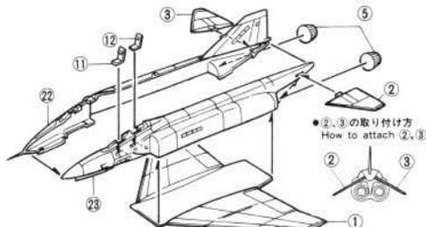
2 胴体部品の組み立て Assembling air intake
