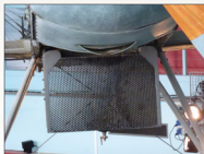
Radiator detail from Waring & Gillow built DH.9 F1258 in the Musée de l'Air et de l'Espace Paris France.
