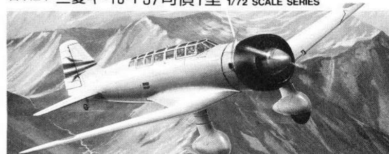
キ15の開発が三菱に指示されたのは、昭和10年7月23日で、この時は、偵察のほか連絡にも使用することが考えられており、機種は高速連絡機になっていた。三菱では河野文彦技師を、主務者として作業に着手し、11年5月に1号機(1501)を完成した。この1号機要求速度の450km/hを、大きく上回る480km/hを記録するなど良好な成績で審査を終え、高速連絡機として適当という判定を受けた。その後、15年2月、本機を司令部偵察機として使用することとなり、風防、操縦席、武装などを改修した機体が作られ、15年5月、審査の結果、九七式司令部偵察機として採用が決定された。
